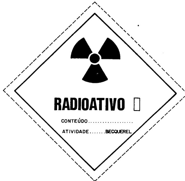
Figura D.1 - Material radioativo - (Categoria I)
