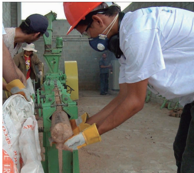
A biomassa que sai do secador rotativo é compactada na briquetadeira e transformada em briquete.
