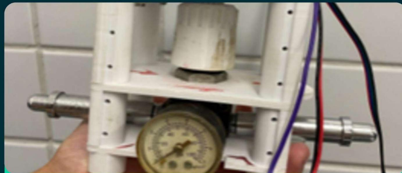
Fluxômetro digital de gás para equipamento de tratamento odontológico a plasma
