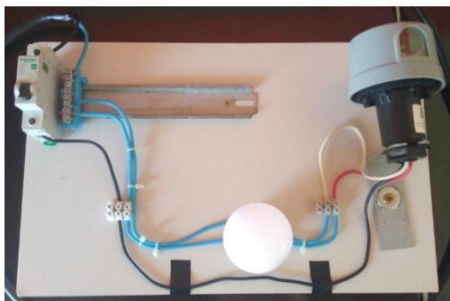
Figura 1 - Experimento demonstrativo de uma aplicação do efeito fotoelétrico
