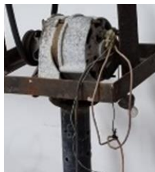
Figura 08 – Alternador de carro comprado em sucata.
