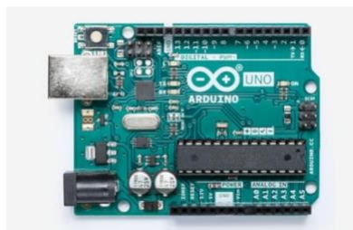
Figura 1 – Imagem ilustrativa do Arduino UNO.
