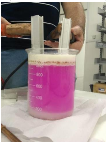
Figura 1 – Processo de Eletrofloculação
