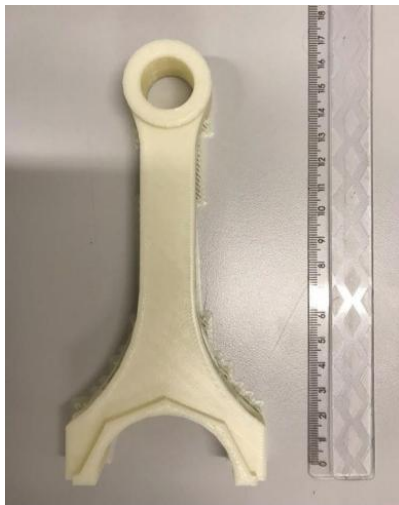
Figura 3: Biela impressa para teste da impressora 3D.
